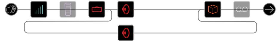
... или два отдельных усилителя и два отдельных блока кабинетов...
