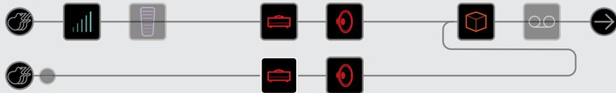
Этот новый входной блок можно присвоить совершенно другому входу. Подобная маршрутизация может быть использована для микширования гитары и вокала или моделей и магнитных звукоснимателей гитары Variax — для отдельной обработки эффектами каждого из каналов.
